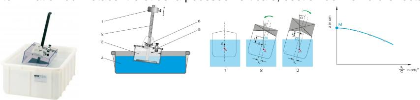
En hydrostatique, le métacentre est un point d'observation important pour évaluer la stabilité des corps flottants. La stabilité décrit la capacité d'un bateau à se redresser depuis une position gîtée.
