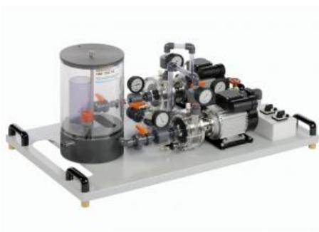
Dans des installations complexes, il est possible d'utiliser des pompes montées en série ou en parallèle. Dans ces cas, les hauteurs de refoulement sajoutent lorsqu'il sagit de montage en série, alors que ce sont les débits de refoulement sajoutent lorsqu'il sagit de montage en parallèle.
