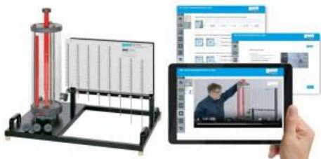
En hydrodynamique, dans le cas d'une vidange horizontale par des orifices, on observe le rapport entre la parabole de la trajectoire, le contour de sortie et la vitesse de sortie.
