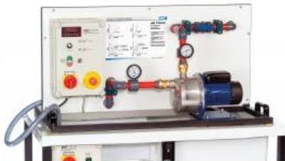
Les pompes centrifuges sont des turbomachines qui sont utilisées pour lacheminement de fluides. Le HM 150.04 permet détudier le fonctionnement dune pompe centrifuge et denregister une caractéristique typique de pompe.
