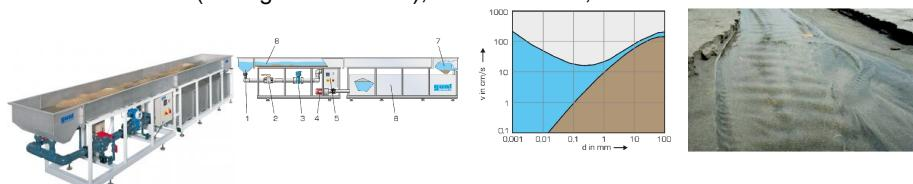
Avec HM 168, des phénomènes importants du transport par charriage dans la zone proche du lit sont montrés avec un écoulement sous-critique.
