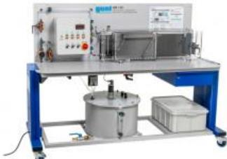
Dans les réservoirs de sédimentation, les matières solides présentes dans les suspensions sont séparées sous effet de la force de gravité.
