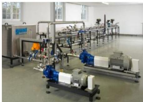
HM 124 permet d'étudier de manière précise différents problèmes de la mécanique de fluides. La grande échelle de l'installation d'essai et l'emploi de composants industriels offrent des résultats proches de ce qui se passe en pratique. Les dimensions de l'installation d'essai offrent suffisamment de sections d'entrée et de sections de sortie pour la formation de l'écoulement.
