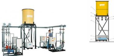
Les bancs de montage HL 962 sont reliés à l'aide d'éléments de tuyauterie HL 962.32 pour former une installation complexe de conduites et de pompes.
