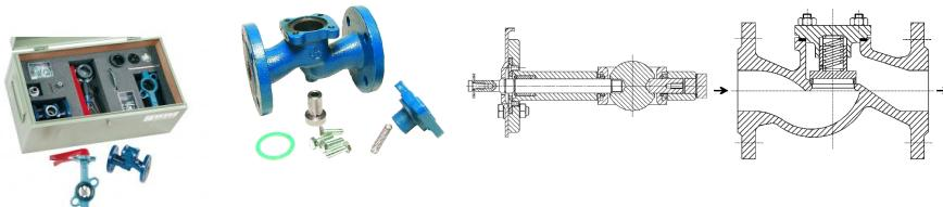
Les soupapes de retenue sont utilisées lorsqu'une inversion du sens d'écoulement n'est pas admissible. Elles doivent faire barrage hermétiquement dans le sens bloquant et offrir une résistance la plus faible possible dans le sens d'écoulement.
