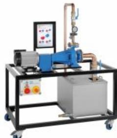
Une procédure de travail complète de réparation de machines réceptrices comme les pompes se compose des étapes de travail suivantes: montage - alignement - contrôle.
