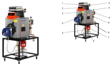
Le banc d'essai est équipé d'un brûleur à fioul.
