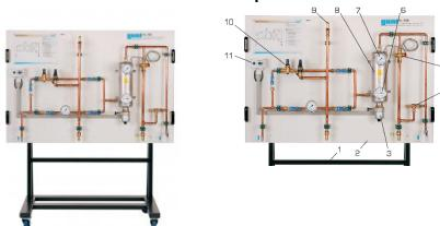
Sur le banc d'essai se trouve un réservoir sous pression chauffé électriquement.
