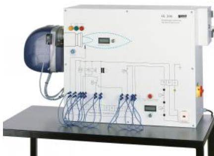
HL 356 démontre le mode de fonctionnement fondamental et le comportement typique d'un brûleur à gaz d'origine lors de perturbations de fonctionnement.
