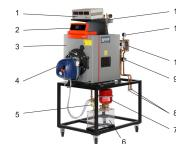
Le banc d'essai est équipé d'un brûleur à fioul.
