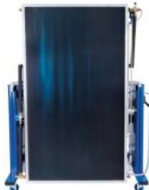
HL 320.03 est un module du système modulaire HL 320 et permet de convertir l'énergie solaire en chaleur avec un capteur plan de conception moderne.
