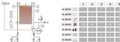
Le module d'essai HL 320.04 comprend un capteur à tubes sous vide et permet la conversion d'énergie solaire en chaleur.
