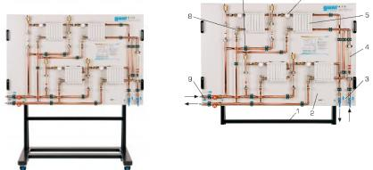
Le banc d'essai comprend un système de tuyauteries avec quatre radiateurs.
