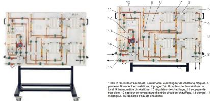
1 pompe de circulation, 2 vanne à quatre voies, 3 thermomètre, 4 capteur de température à cadran, 5 panneau, 6 vanne thermostatique, 7 purge gaz, 8 capteur de température de local, 9 thermomètre bimétallique, 10 régulateur de température, 11 soufflage de température, 12 soupape de décharge, 13 vanne de chauffage, 14 pompe, 15 radiateur d'eau de chaleur.
