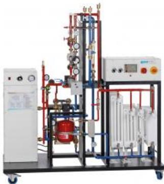
Le banc d'essai comprend deux circuits de chauffage autonomes équipés d'une vanne à trois voies et d'une vanne à quatre voies.
