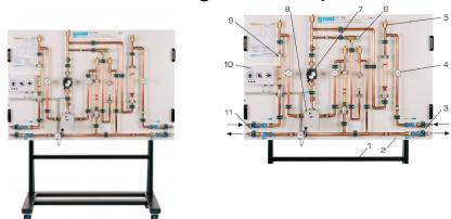
Le banc d'essai a été conçu principalement pour la formation aux techniques de chauffage et sanitaire. Une vanne à trois voies assure dans un système de chauffage la régulation de la température de circulation et d'entrée circuit de chauffage. Une pompe est montée dans le circuit. L'équilibre de pression dans le système est effectuée par le biais d'une soupape de décharge. Des thermomètres à bilame affichent la température à tous les points importants du circuit de chauffage.
