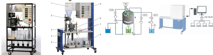
Le CE 630 permet d'extraire le composant soluble d'un mélange de matière solide à l'aide d'un extracteur rotatif. Dans le fonctionnement continu à trois étapes, un solvant pur (eau distillée) est refoulé d'un réservoir à lasperateur de la première étape d'extraction et distribué au-dessus du mélange de matière solide (matière à extraire).
