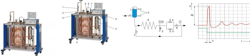
Les coups de béliger dans les tuyauteries posent de sérieux problèmes à tout système technique, car ils peuvent causer des dommages importants sur les tuyauteries, les robinetteries et les composants d'une installation.
