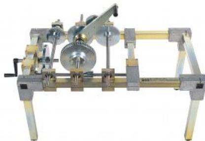
Les boîtes de vitesse sont également appelées variateurs ou harnais d'engrenage à changement de vitesse. Elles se distinguent par le fait que la vitesse de rotation est transmise différemment par diverses paires de roues dentées.
