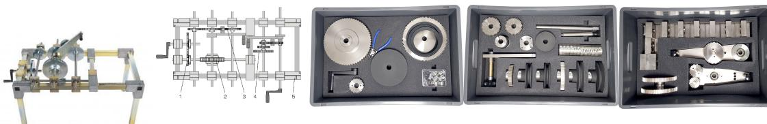
Les boîtes de vitesse sont également appelées variateurs ou harnais d'engrenage à changement de vitesse. Elles se distinguent par le fait que la vitesse de rotation est transmise différemment par diverses paires de roues dentées.
