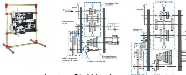
L'engrenage d'un tour GL 200 présente toutes les caractéristiques et propriétés essentielles d'un tour datelier: un engrenage principal commutable, un engrenage d'avance pour l' entraînement de la vis-mère (train baladeur Norton), un harnais d'engrenage à changement de vitesses et un renversement de marche.
