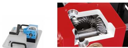
Ces modèles en coupe permettent d'expliquer de façon simple et précise le mode de fonctionnement des éléments constitutifs d'une machine, par exemple d'un embrayage à disques, de différents engrenages ou d'une chaise palier.
