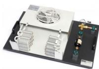
Une soupape de détente thermostatique, un filtre / sécheur et un élément plafonnier (évaporateur) sont montés sous forme de modèles de coupe sur une plaque de base.
