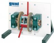
Véritable diaphragme normalisé transformé en modèle en coupe.
