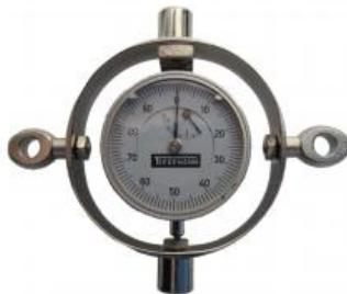
Avec ce dynamomètre universel, les forces de traction ou de compression peuvent être mesurés en fonction de la position de montage.
