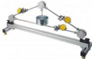
Le FL 111 représente un treillis idéal. Dans le système plan, les barres sont soumises uniquement à la compression et à la traction.
