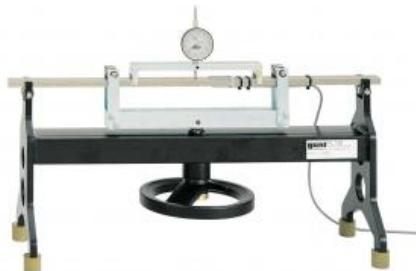
Utilisés comme outils universels dans l'analyse des contraintes expérimentales, les jauge de contrainte offrent la possibilité de transformer les grandeurs mécaniques en grandeurs électriques.
