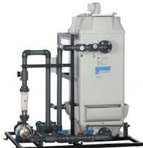
La tour de refroidissement par voie humide s'intègre dans le circuit d'eau de refroidissement de la centrale thermique à vapeur ET 830.
