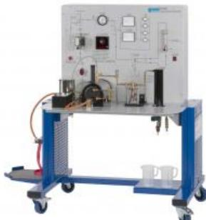
**ET 810 Centrale thermique à vapeur avec machine à vapeur (Réf. 061.81000)**
