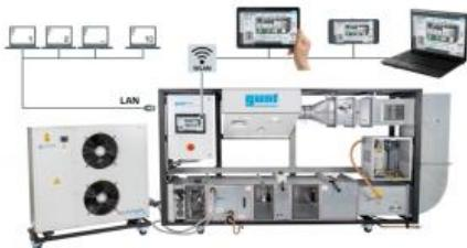
La structure dessai représente une installation de climatisation et de ventilation réelle.
