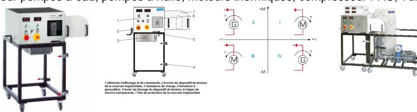
Le HM 365 est le module de base de la série FEMLine; il permet de réaliser des études et des expériences sur des machines à fluide.
