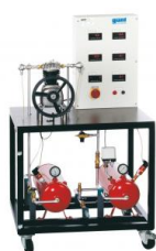
1 compresseur, 2 probe de courant, 3 réservoir d'aspiration, 4 soupape de purge avec siphonneur, 5 soupape de sécurité, 6 réservoir auxiliaire, 7 fréquence, 8 électrovanne, 9 armature de commande avec affichage numérique
