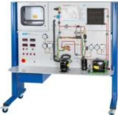
Les installations frigorifiques à deux niveaux de compression sont utilisées dans le cas où des températures particulièrement basses doivent être atteintes.
