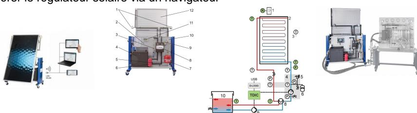
Le banc d'essai HL 313 permet de montrer les principaux aspects du réchauffement des eaux industrielles par hélio thermie.
