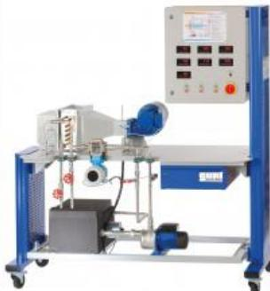
Ce banc d'essai permet d'effectuer des essais quantitatifs sur un échangeur de chaleur eau / air. Le banc d'essai possède un circuit d'eau chaude fermé avec dispositif de chauffage, réservoir, pompe et débitmètre.
