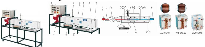
Le banc d'essai est constitué d'un canal isolé, à travers lequel de l'air est aspiré à l'aide d'un ventilateur.
