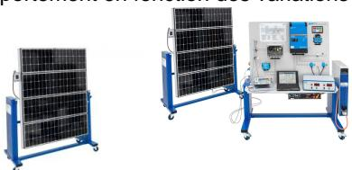
L'ET 255.02 est destiné à servir comme source d'énergie solaire pour le système d'énergie solaire ET 255 et comprend 4 modules photovoltaïques sur un bâti pivotant.
