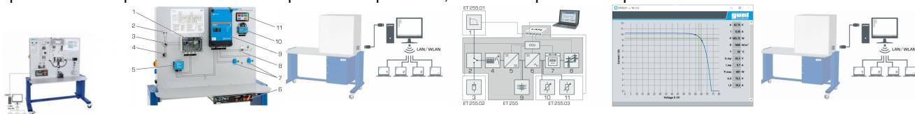
L'électricité produite par les installations photovoltaïques peut être utilisée pour l'approvisionnement d'un réseau électrique public (opération parallèle au réseau) ou pour la consommation locale (opération en îlotage).
