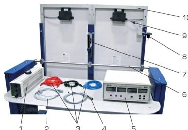
1 résistance à courant, 2 câble d'alimentation, 3 jeu de câbles pour le montage en série et en parallèle,
