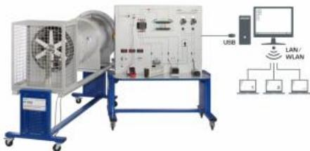
Le ET 220 sert à étudier la conversion de l'énergie cinétique du vent en énergie électrique.
