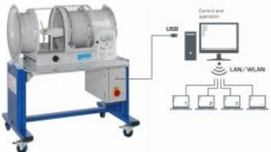
Sur les éoliennes modernes, la puissance absorbée issue du vent est ajustée aux différentes conditions de vent. Sur la plage de vents forts, on limite la puissance absorbée afin de protéger l'installation.
