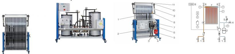
Le module d'essai HL 320.04 comprend un capteur à tubes sous vide et permet la conversion d'énergie solaire en chaleur.
