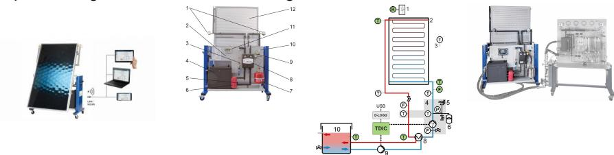
Le banc d'essai HL 313 permet de montrer les principaux aspects du réchauffement des eaux industrielles par héliothermie.
