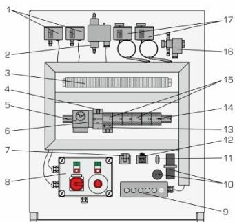
1 pressostat, 2 pressostat différentiel, 3 berettes à bornes, 4 disjoncteur avec limiteur de courant de démarrage, 5 programmeur, 6 disjoncteur thermistor, 7 relais de démarrage PTC, 8 armoire de commande, 9 lampes, 10 condensateur, 11 disjoncteur bimétal, 12 relais de démarrage électromagnétique, 13 relais de protection ajustable, 14 relais temporisé, 15 contacteurs, 16 électrovanne, 17 thermostat.
