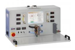
L'appareil d'essai montre le refroidissement à l'aide de l'effet Peltier.
