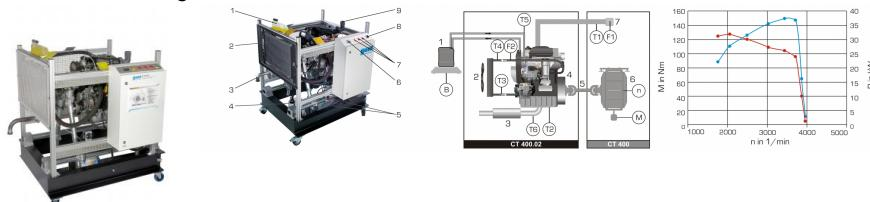
Le moteur CT 400.02, associé à l'unité de charge CT 400, forme un banc dessai pour moteurs complets.
