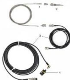
Pour les essais avec indication de pression dans le cylindre sur le moteur de test CT 400.02, le moteur est doté d'un capteur de pression miniature.
