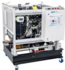
Le moteur CT 400.01, associé à l'unité de charge CT 400, forme un banc d'essai pour moteurs complet.
