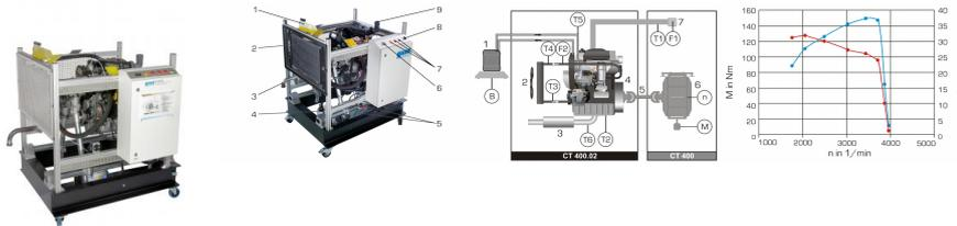
Le moteur CT 400.02, associé à l'unité de charge CT 400, forme un banc d'essai pour moteurs complet.
