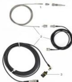
Pour les essais avec indication de pression dans le cylindre sur le moteur de test CT 300.05, le moteur est doté d'un capteur de pression miniature.
