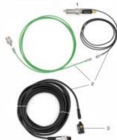
Pour les essais avec indication de pression dans le cylindre sur le moteur de test CT 300.04, la bougie normale est remplacée par une bougie instrumentée.
