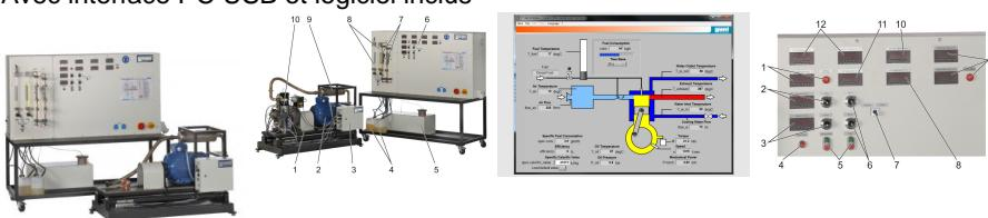
Ce banc dessai permet de mesurer la puissance des moteurs à combustion interne jusqu'à une puissance de 11kW.
