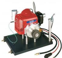
En combinaison avec le banc dessai CT 159 et le dispositif de freinage et entraînement HM 365, le moteur essence deux temps simple convient parfaitement à l'enseignement des principes de base du fonctionnement et de la technique de mesure sur moteurs.
